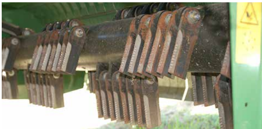
Sistem za drobljenje slame PreChop zdrobi slamo in poveča njeno vpojnost. Sestavljen je iz dodatnega rotorja, nameščenega pred pobiralom, ki s 96 noži na protinožih slamo drobi in jo dovaja potisnemu valju. Teoretična dolžina drobljenja znaša samo 21 mm. Prednost je še v čiščenju slame (na pobiralo in v balo pride manj zemlje).
