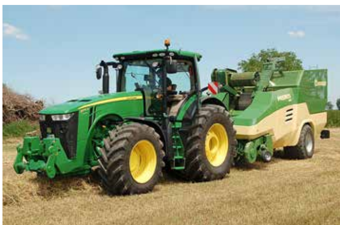
Čeprav je za pogon peletirke služil JD s 400 KM, se je po njivi pomikal po poljse. Seveda je tudi zmogljivost bila še daleč od obljubljenih 5 ton na uro.
