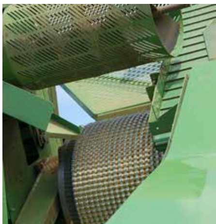
Matrica peletirke, nad njo čistilni valj, od koder zdrobljeni delci peletov padajo nazaj v dovajalni sistem.
