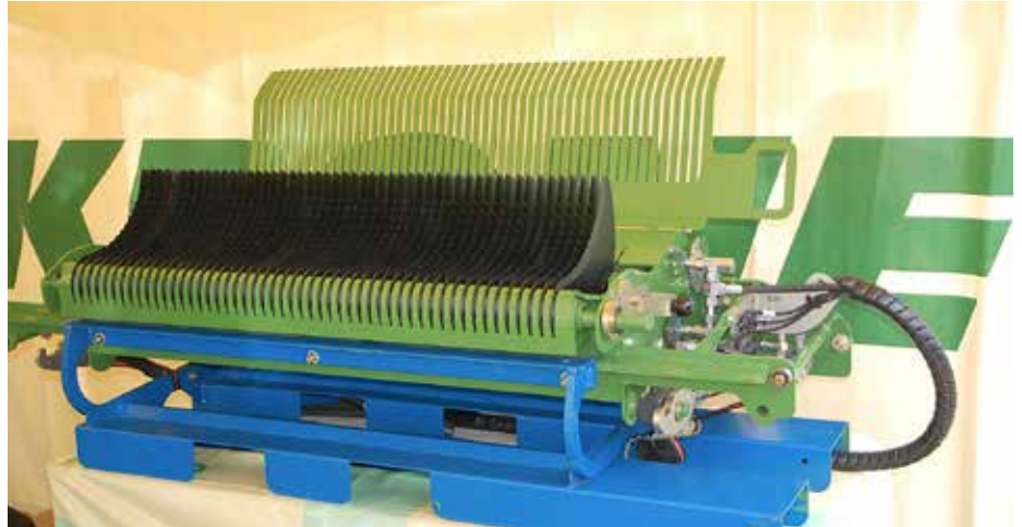
Nova rezalna naprava VariCut z 51 noži omogoča kratko in natančno rez. Kljub kratki rezi (teoretično 22 mm) je struktura slame ohranjena. Noži so razdeljeni v šest skupin, ki jih lahko poljubno vklapljamo in izklapljamo ter tako dobimo različne dolžine rezi.
