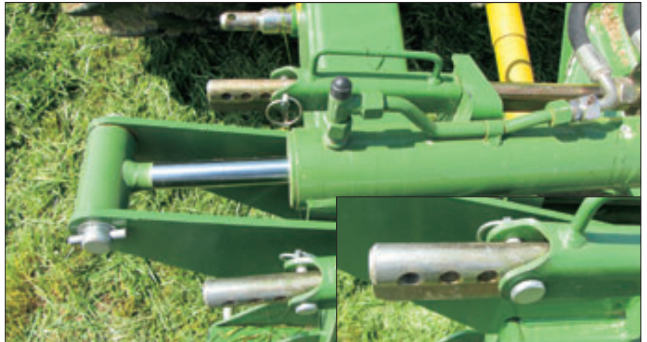
Hidravlični cilinder za dviganje in sistem za nastavitvev naležne mase kosilnega grebena; na manjši sliki se vidijo 4 izvrtine za uravnavanje naležne mase.
